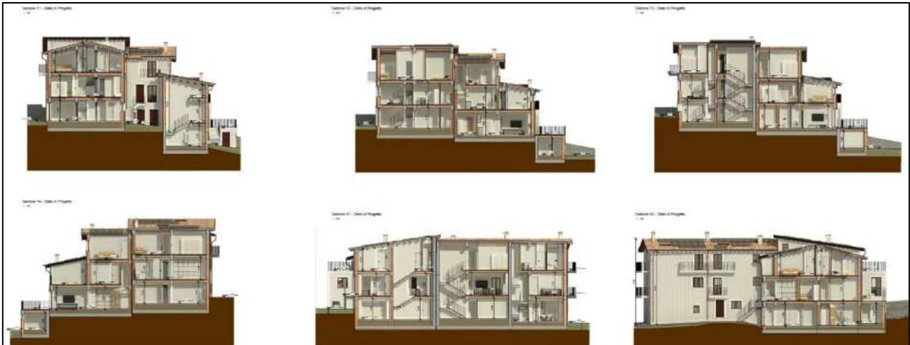
*A causa dei gravi danni alle strutture portanti in elevazione riportati dall'immobile in seguito al sisma del 24/08/2016 ad oggi risulta interamente crollato/demolito. Il progetto di ristrutturazione edilizia mediante ricostruzione si articolerà sulla realizzazione di sei edifici collegati mediante giunti sismici.*
