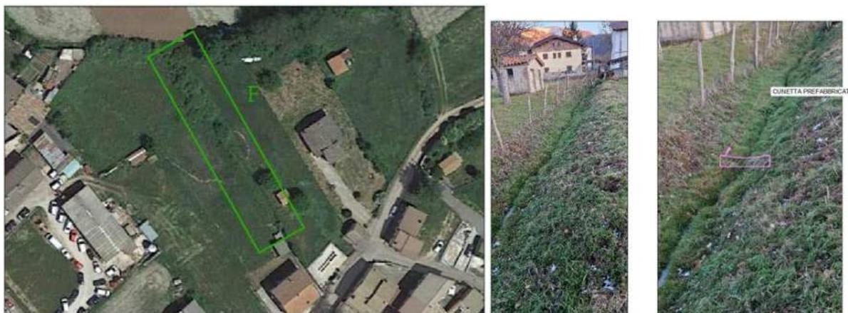
Per il tratto 1F è prevista la realizzazione di nuove cunette stradali prefabbricate in cemento vibrato, costituite da embrici di misura 50x50x20, poste in opera a seguito di scavo e costipamento del terreno di appoggio della canaletta, per il deflusso ordinario delle acque.
