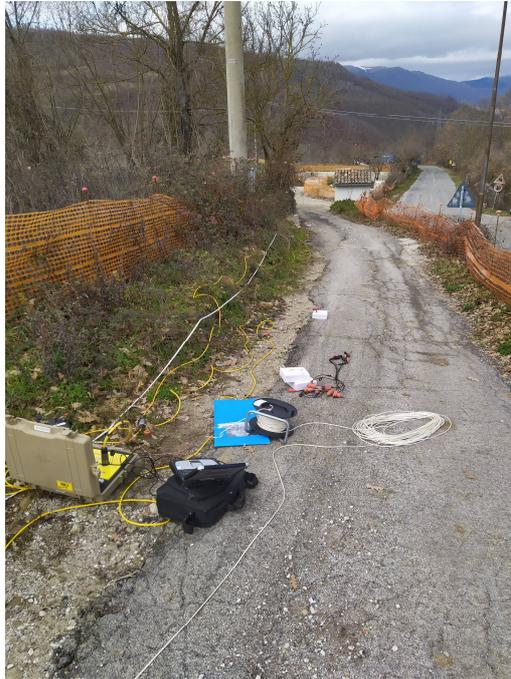
*Stazione misura stesa sismica a rifrazione
